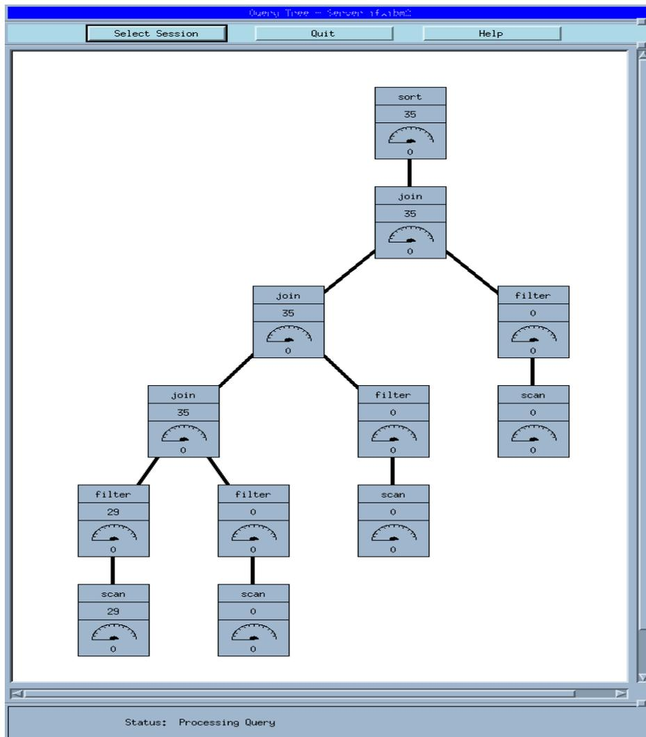
Gerade bei „Langläufern“ im Bereich SQL mit großer Datenmenge kann so eine voraussichtliche Gesamtlaufzeit abgeschätzt werden. Bei komplexen SQL Statements lässt sich mittels xtree auch schnell sehen, in welchem Bereich einer Verknüpfung die großen Datenmengen verarbeitet werden müssen.
